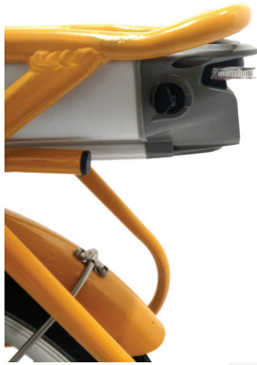
Bild 8: Steckkontakt, ziehen Sie die Lasche zu sich hin.
