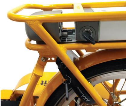
Bild 7: Taste drücken und nach links drehen, der Akku kann entnommen werden.
