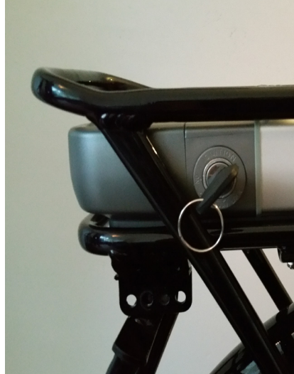
Abb. 10: Schlüssel senkrecht – Batterie ist aus.
