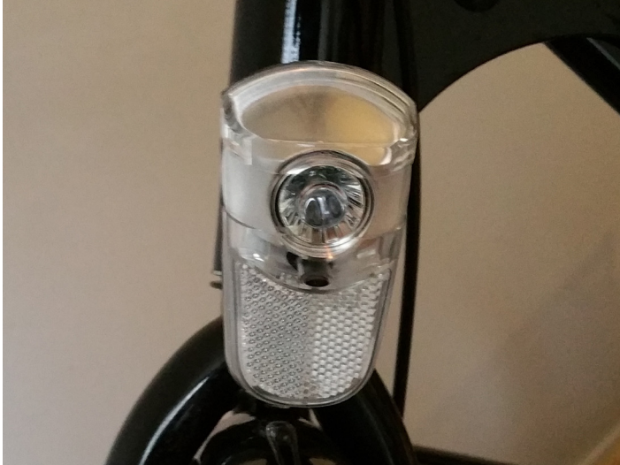
Abb. 21: Vorderlicht, schwarzer Schalter in der Mitte .
