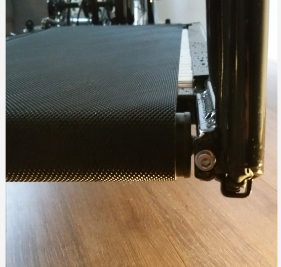
Abb. 8: Schraube zur Spannungseinstellung, rechts
