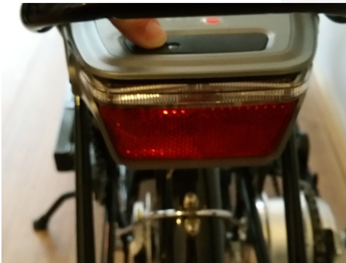
Abb. 22: Rücklicht, Schalter an der Batterie.
