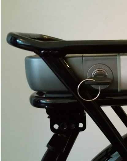
Abb. 9: Schlüssel waagrecht – Batterie ist an.
