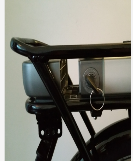
Abb. 11: Schlüssel einstecken, drücken und nach links drehen.
