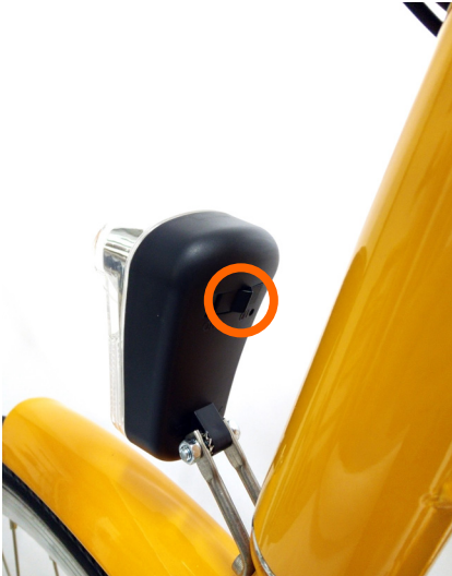
Afbeelding 19: Voorlicht, zwarte knop in het midden.
