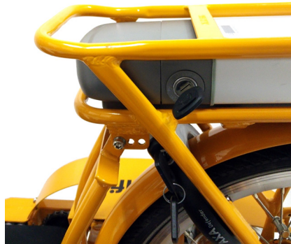
Afbeelding 8: Sleutel van contact af, accu is uit.
