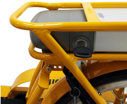
Afbeelding 7: Sleutel op contact, accu is aan.
