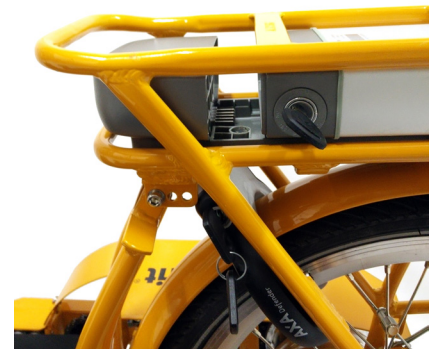
Afbeelding 9: Sleutel indrukken en linksom, accu kan eruit.
