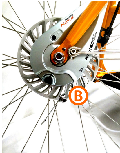
Afbeelding 15: Voorrem ontkoppellen punt B.
