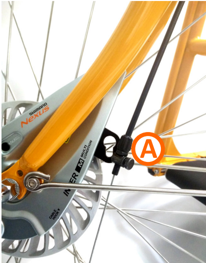
Afbeelding 14: Voorrem ontkoppelen punt A.
