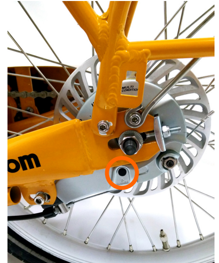
Afbeelding 21: Dopje van de rem afhalen en rem vet toevoegen
