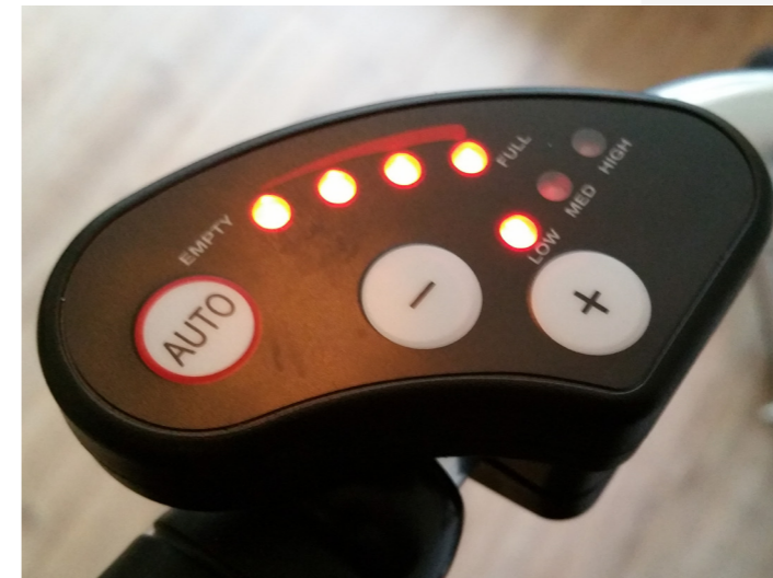
Afbeelding 20: Display, accu is aan.
