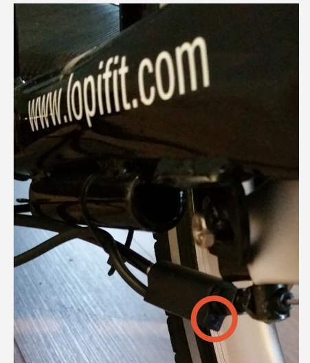
Afbeelding 6: Sensor, lampje brandt niet.
