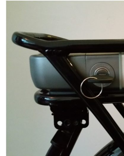
Afbeelding 9: Sleutel op contact, accu is aan.
