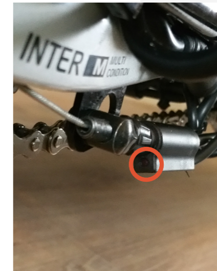
Afbeelding 5: Sensor, lampje brandt niet.
