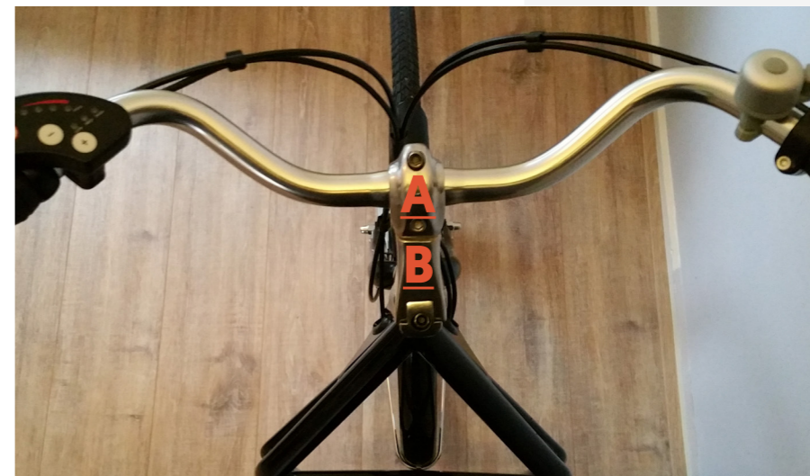
Afbeelding 13: Hier ziet u de stuurbocht [A] en de stelschroef van de stuurpen [B].
