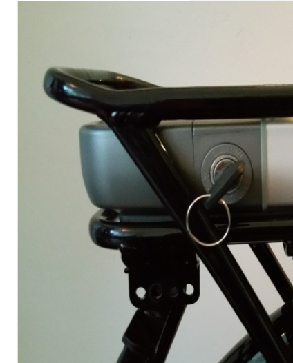
Afbeelding 10: Sleutel van contact af, accu is uit.
