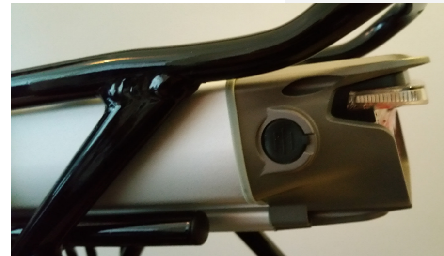
Afbeelding 12: Stekkercontact, trek het lipje naar u toe.
